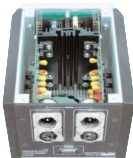
O pełnej symetrii układu wzmacniacza świadczy nie tylko brak wejść cinch, ale i rozmieszczenie płytek lewego i prawego kanału
