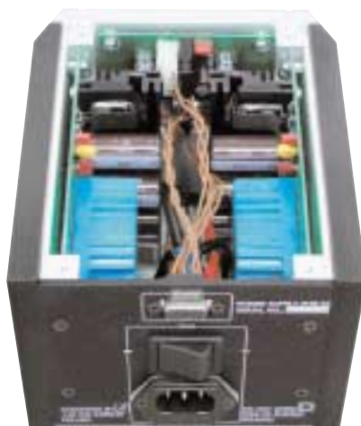
Jak przystało na konstrukcję high-endową, zasilacz zrealizowano w topologii dual-mono. Wszystkie napięcia wyjściowe są przekazywane za pośrednictwem złącza komputerowego
